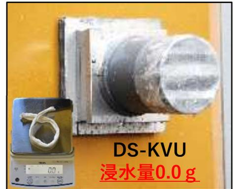
雨量140mm/h・1時間の実験でも、内部への浸水無し(浸水量0.0g)→大佐HPで動画配信中
